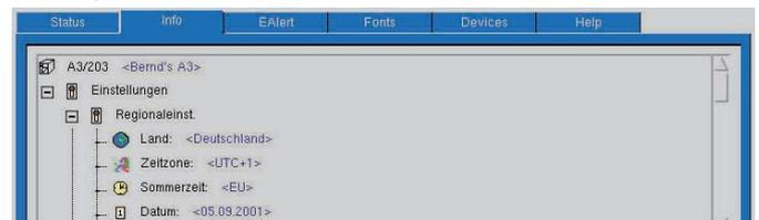
Parameter können über eine HTML-Seite angezeigt und eingestellt werden. Über das File Transfer Protokoll (FTP) wird die Firmware aktualisiert und die CompactFlash-Speicherkarte verwaltet. Statusmeldungen können abgerufen oder per E-mail oder SNMP versandt werden.
